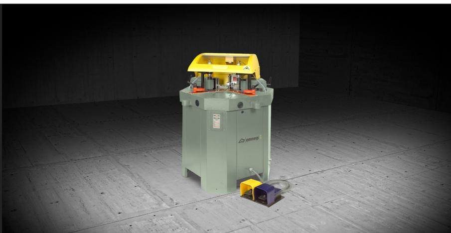
Чеканочный станок для закрытия углов алюминиевых профилей для дверей, окон и фасадов. Легко регулируется благодаря перемещению пуансонов. Ножевые блоки оснащены быстросъемным креплением и магнитами для предотвращения их падения. Оснащен цифровым устройством считывания показателя смещения чеканочных головок и опорной вилки профиля. Регулировка упрощается благодаря легко читаемому дисплею.
