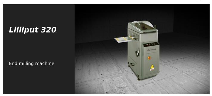
Горизонтальный торцовочный станок с электропневматической подачей. Фрезерование вне опорной поверхности под углом +45° / 90° / -45°. Высокая скорость вращения инструмента служит для лучшего качества обработки окрашенного профиля и обработок вне угольной поверхности. Быстрая смена фрезеровочного узла с помощью пневматического управления. Рабочий стол с защитой от царапин. Встроенное защитное ограждение рабочей зоны с широким внутренним обзором.
