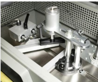
**Зажимной узел и положение вне прямоугольной опоры**
