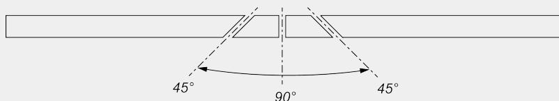
Механическая регулировка промежуточных углов наклона
