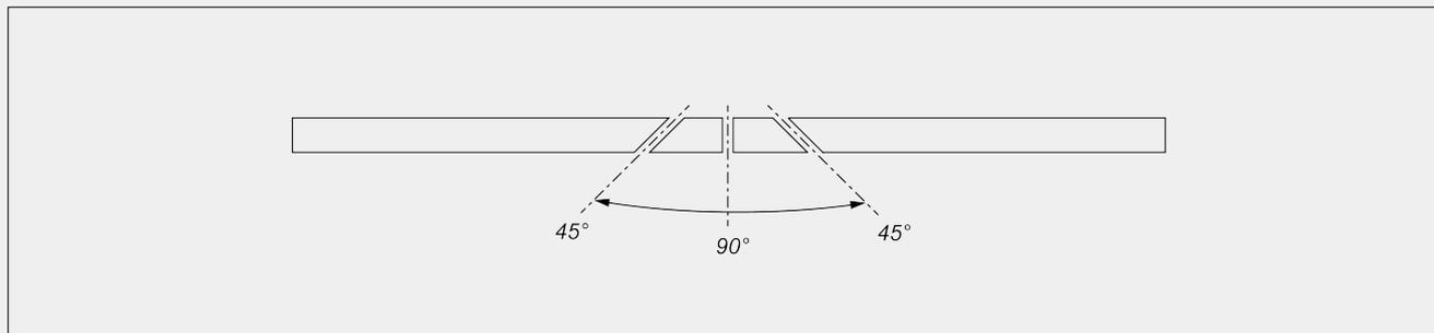
Механическая регулировка промежуточных углов наклона
