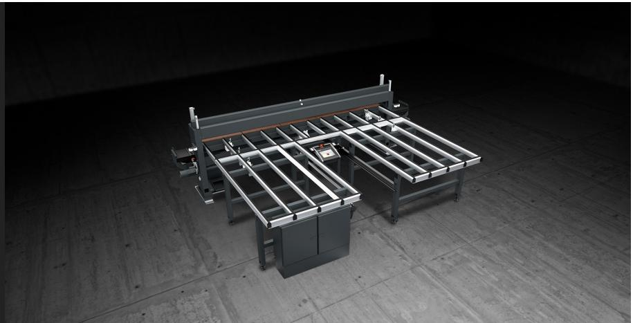
MOD-END RIFILA является полуавтоматическим обрезным 2-х осевым станком для рам из ПВХ. Он оснащен режущим узлом с ЧПУ и регулируемой скоростью движения.
