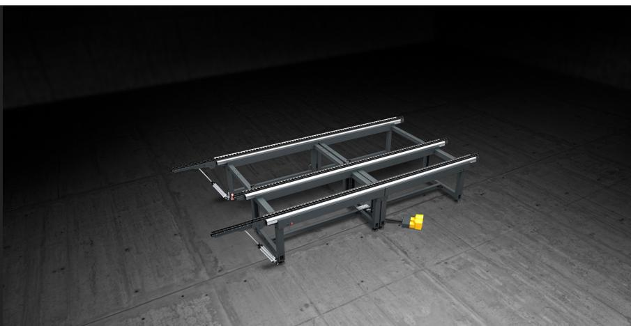
Раздвижной модульный стол больших размеров предназначен для сборки переплетов и секций фасада. Оборудован 3 отдельными рабочими поверхностями: одна – с покрытием из мягкого противоскользящего ПВХ для проведения сборочных операций, другая – с покрытием из антифрикционного твердого ПВХ для выполнения операций вращения и рольганг для перемещения по линии.
