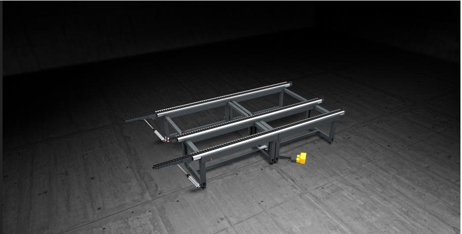
Раздвижной модульный стол больших размеров предназначен для сборки переплетов и секций фасада. Оборудован 3 отдельными рабочими поверхностями: одна – с покрытием из мягкого противоскользящего ПВХ для проведения сборочных операций, другая – с покрытием из антифрикционного твердого ПВХ для выполнения операций вращения и рольганг для перемещения по линии.
