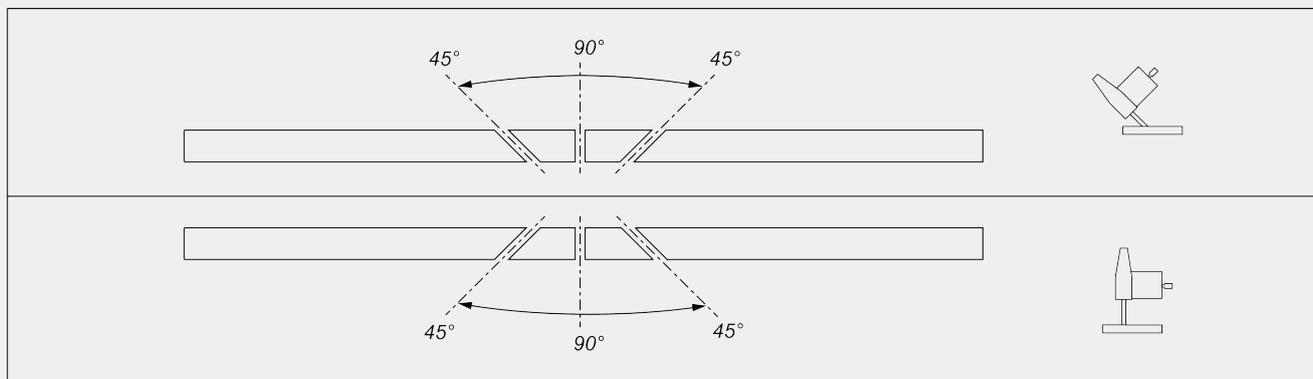
Механическая регулировка промежуточных углов наклона
