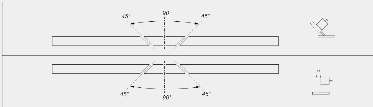
Механическая регулировка промежуточных углов наклона
