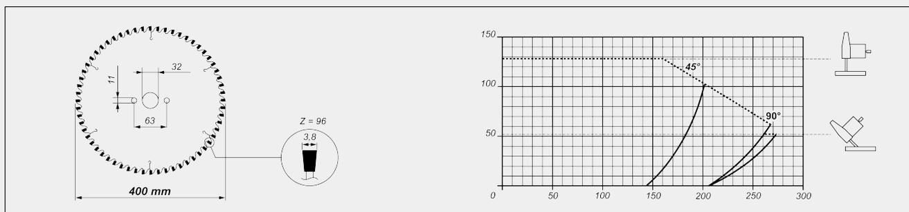
НАКЛОН РЕЖУЩЕГО УЗЛА
