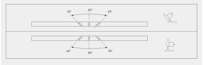
Механическая регулировка промежуточных углов наклона
