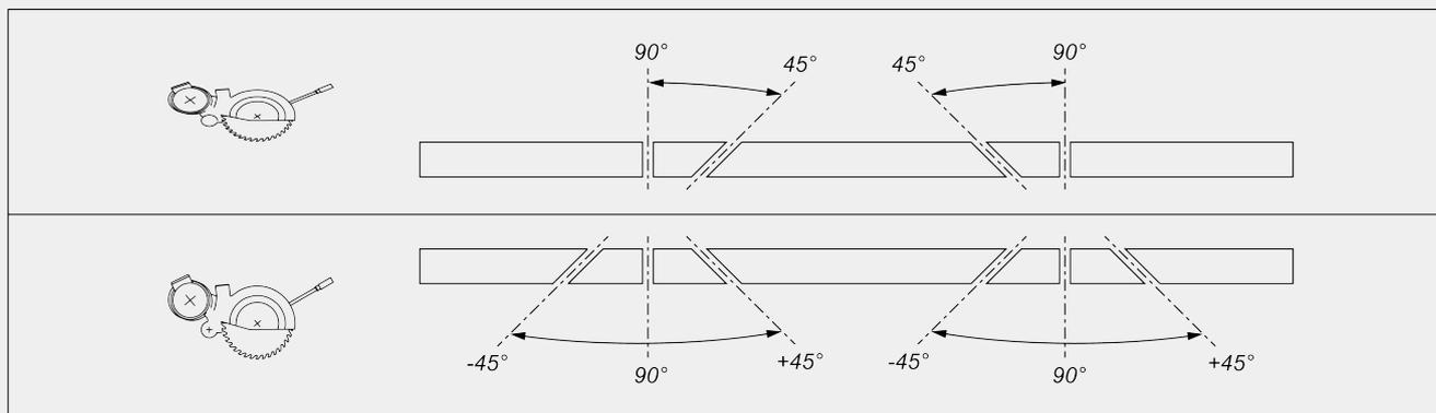
Механическая регулировка промежуточных углов наклона
