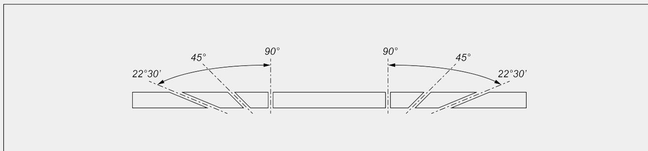
Механическая регулировка промежуточных углов наклона
