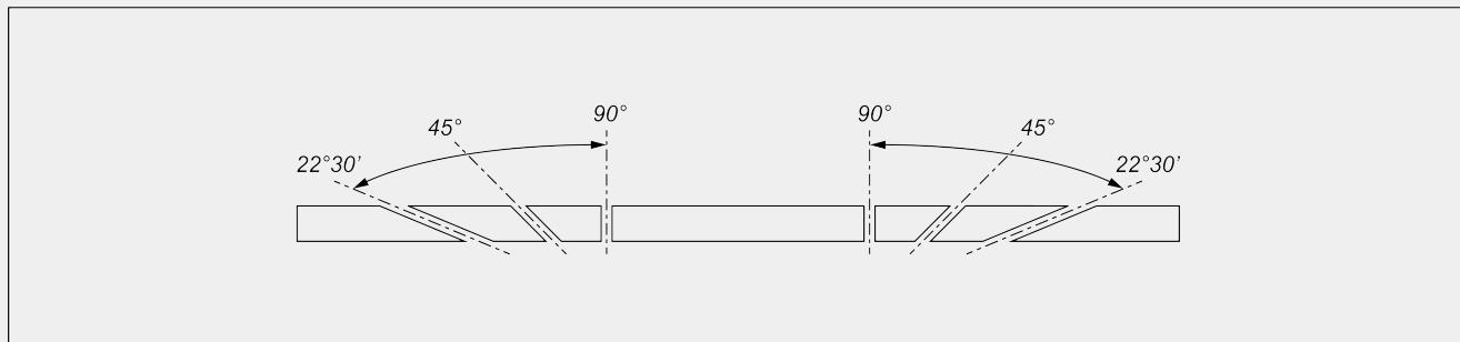
Механическая регулировка промежуточных углов наклона
