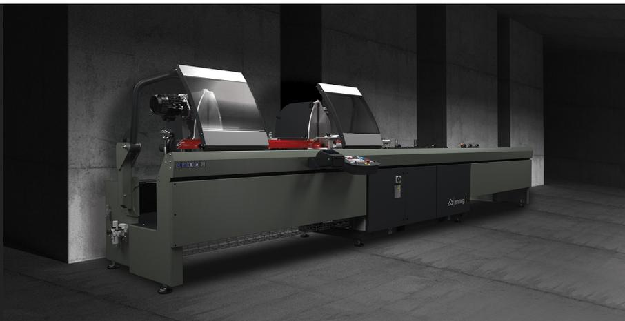
Электронный двухголовочный отрезной станок с автоматическим перемещением подвижной головки с помощью бесщеточного двигателя, управляемого числовым программным управлением. Пневматический наклон режущих узлов от 90° до 22°30' (наружу) с механической системой регулировки промежуточных углов. Гидравлическая подача режущего диска.
