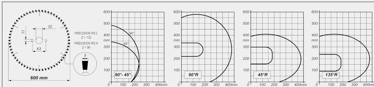
**НАКЛОН РЕЖУЩЕГО УЗЛА**
