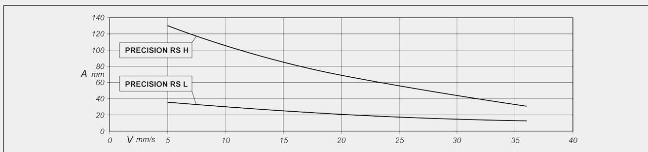
A = контактная дуга (мм)      V = скорость продвижения режущего диска (мм/с)
