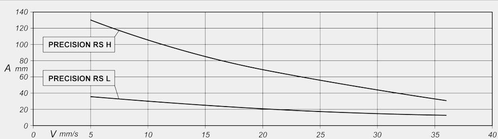
A = контактная дуга (мм)
