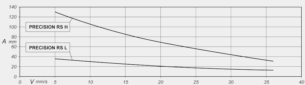
A = контактная дуга (мм) V = скорость продвижения режущего диска (мм/с)
