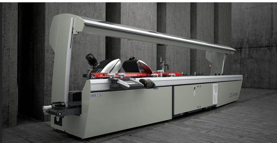
Двухголовочный отрезной станок с 5 управляемыми осями для алюминия, ПВХ и легких сплавов, с автоматическим перемещением подвижной головки и электронным управлением всеми углами от 45° (внутренний) до 15° (внешний) с точностью, в пределах каждого градуса, до 280 позиций. Подача режущих дисков в базовой комплектации приводится в действие парой гидравлических цилиндров. Режущий диск диаметром 550 мм. Доступен для резки полезной длины в размере 5 или 6 м.
