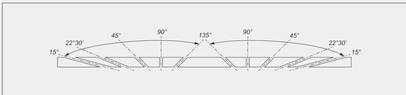
Электронная регулировка промежуточных углов наклона
