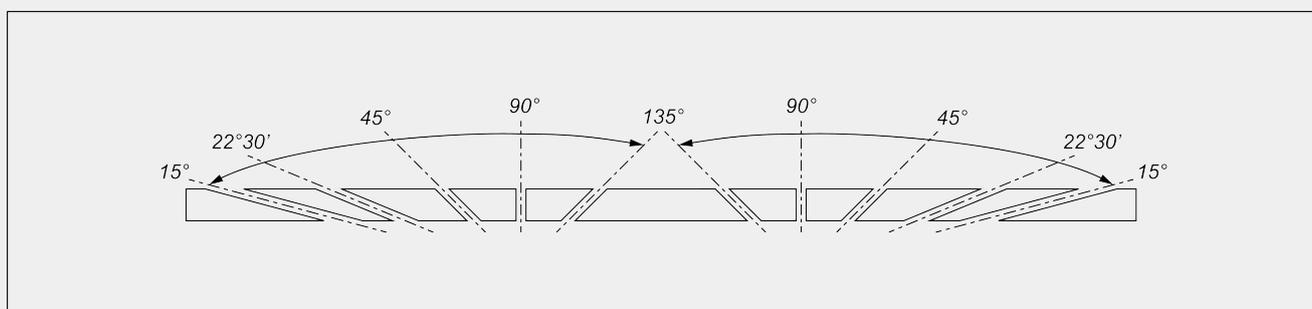
Электронная регулировка промежуточных углов наклона
