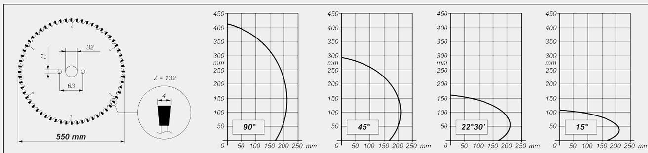
НАКЛОН РЕЖУЩЕГО УЗЛА
