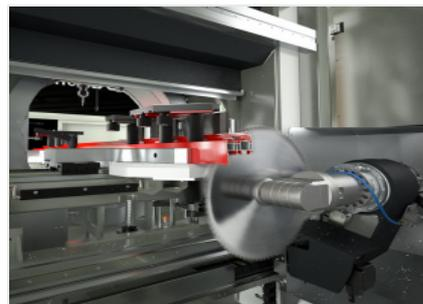
**Горизонтальный модуль резки**
