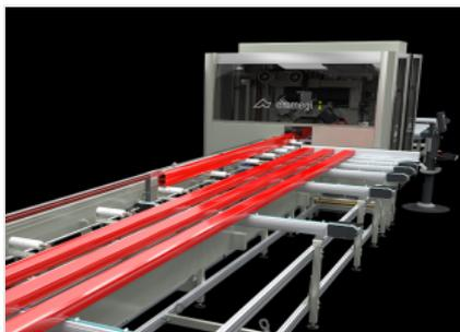
**Автоматическая подача профилей и выгрузка деталей**
