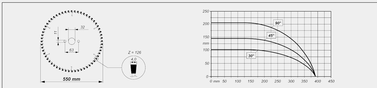
**НАКЛОН РЕЖУЩЕГО УЗЛА**
