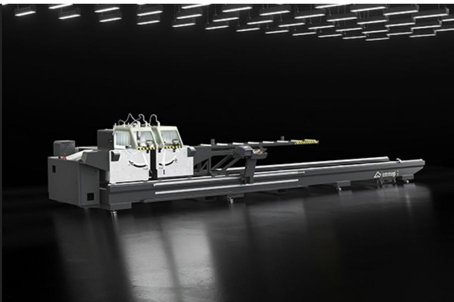
Электронный двухголовочный пильный станок с радиальным движением режущих дисков, автоматическим перемещением подвижной головки на шарикоподшипниковых ползунах с шестеренно-реечной передачей; внутренний наклон до 30°, разработана для резки профилей крупных размеров. Подача режущего диска приводится в действие парой гидравлических цилиндров.
