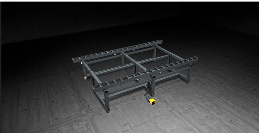
Модульный стол больших размеров предназначен для сборки и перемещения на линии секций фасада. Он оборудован двумя роликовыми конвейерами, покрытыми мягким ПВХ; расстояние между двумя роликовыми дорожками регулируется вручную в зависимости от ширины обрабатываемого переплета. Пневматическая система позволяет блокировать ролики при выполнении этапов технологического процесса.
