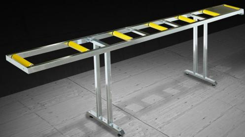
Стальная конструкция из трубчатых профилей с регулируемыми по высоте ножками: с роликами шириной 240 мм длина рольганга составляет 3.500 мм; с роликами шириной 440 мм длина рольганга составляет 4.000 мм.
