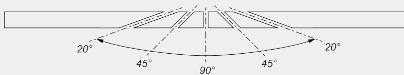
Механическая регулировка промежуточных углов наклона
