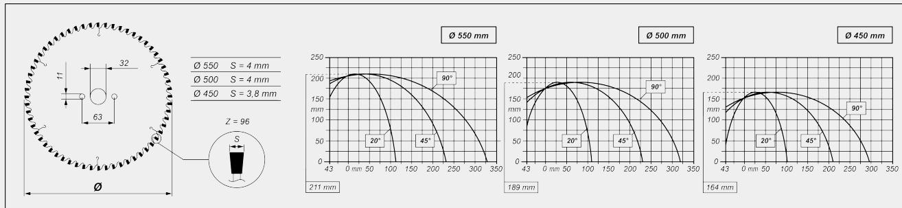
**НАКЛОН РЕЖУЩЕГО УЗЛА**
