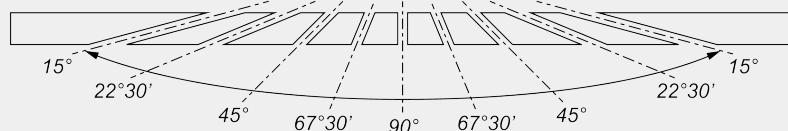
Механическая регулировка промежуточных углов наклона
