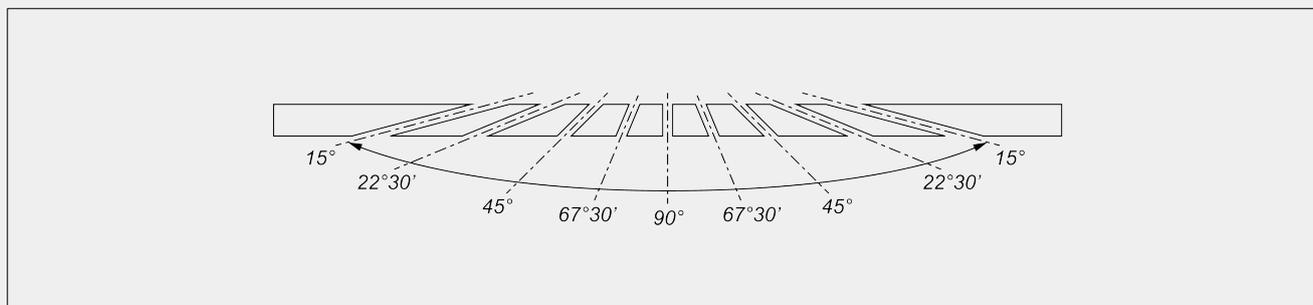
Механическая регулировка промежуточных углов наклона
