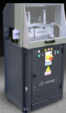
Отрезной станок с одной головкой, подъемным режущим диском, загрузочной стороной слева для резки под углом 15° слева и 15° справа, а также, под промежуточными углами.
