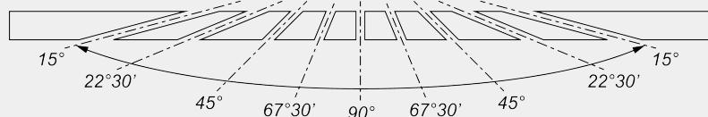
Механическая регулировка промежуточных углов наклона
