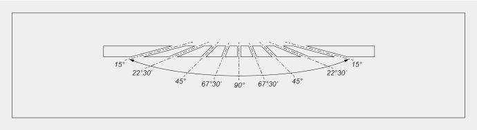
Механическая регулировка промежуточных углов наклона
