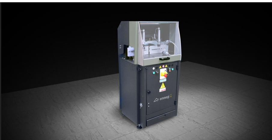
Отрезной станок с одной головкой, подъемным режущим диском, загрузочной стороной слева для резки под углом 15° слева и 15° справа, а также, под промежуточными углами.
