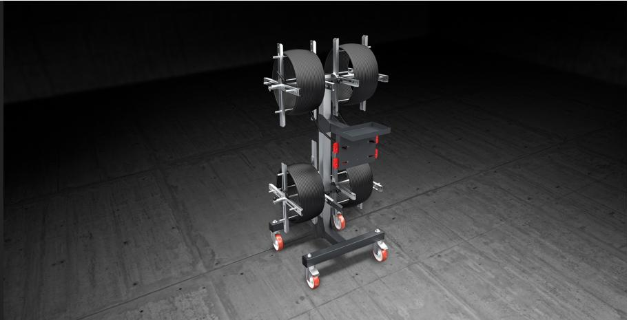
Каретка-держатель уплотнений. Мотальный вал с фрикционным механизмом и направляющая ленты обеспечивают разматывание прокладки без повреждения. Оборудована системой быстрой смены бобин.
