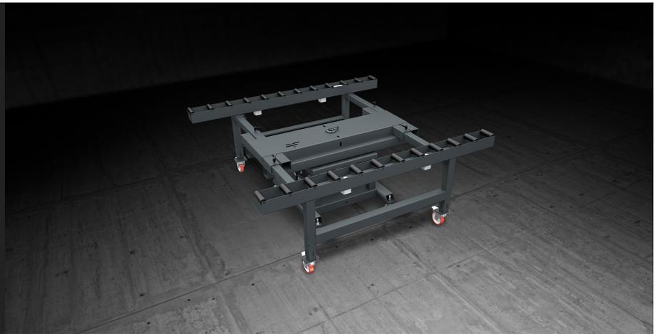
Модульный стол предназначен для сборки и перемещения на линии секций фасада. Он оборудован двумя роликовыми конвейерами, покрытыми мягким ПВХ; расстояние между двумя роликовыми дорожками регулируется в зависимости от ширины переплета. Пневматическая система позволяет блокировать ролики при выполнении этапов технологического процесса. Весь стол может поворачиваться на 360° с целью упрощения операций сборки и герметизации секции; наклонное положение удерживается пневматическим управлением.
