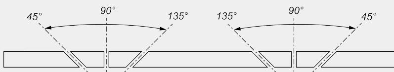
Электронная регулировка промежуточных углов наклона
