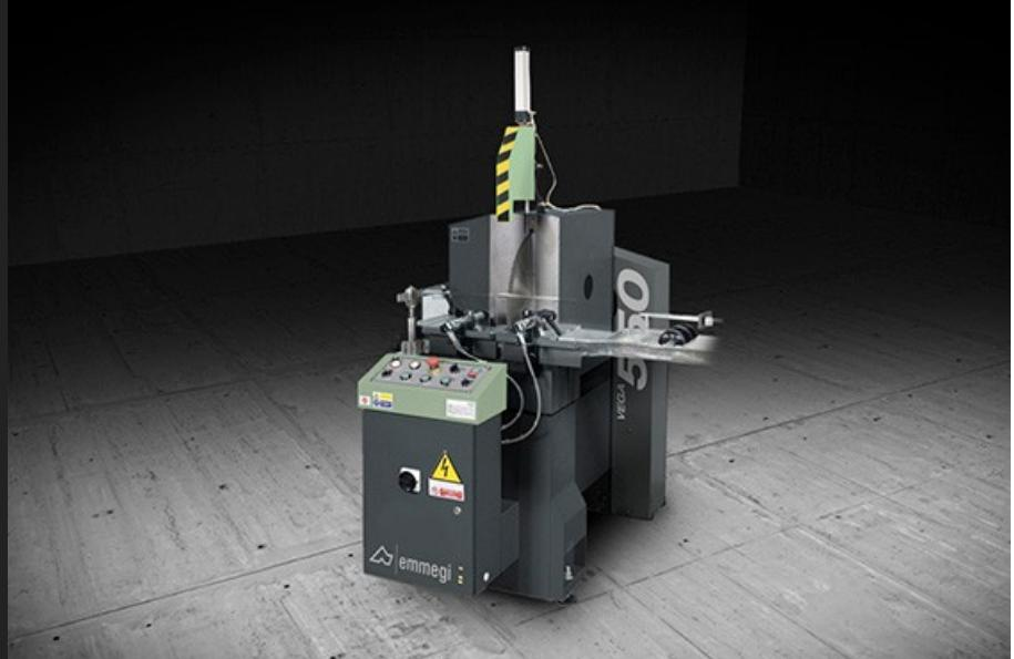
Одноголовочный отрезной станок с фронтальным режущим диском, загрузкой слева и двойным опрокидыванием с боковой стороны с пневматическим управлением в фиксированных положениях: 45° влево и 90°, 45° и 22°30' вправо. Специальный механический упор позволяет также выполнять резку под промежуточными углами.
