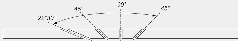
Механическая регулировка промежуточных углов наклона
