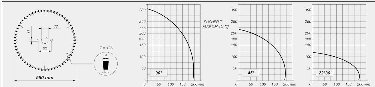
НАКЛОН РЕЖУЩЕГО УЗЛА
