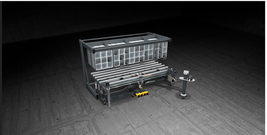
专用于五金件装配的工作台。具有宽大的工作台面、可以加工大尺寸窗框。工作台可包有 3 种不同材料（低摩擦 PVC 用于加工铝合金、刷子用于加工 PVC、毛毡用于加工木头）、允许加工任何门窗。作为 BMF 3500 的标准配置、可以进行五金件的测量、通过液压气动剪床进行切割、并通过自动进给的拧紧装置拧紧。另外、还可以选择其它配件：长插销用的三轴钻孔机、长插销用的铣削套件、铰链孔用的钻孔机、切屑收纳抽屉、五金件仓和用磁性探头来测量玻璃固定槽的自动测量装置。
