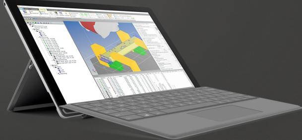
关于加工中心的编程，Emmegi 提供 CAMplus 软件（可与 Shape、DriverCAD 和 DriverCL 附加模块集成）。CAMplus 能够以三维图形方式进行加工编程，显示型材和刀具。该软件包括最常见的图形（孔、槽、矩形等），可以通过附加的 Shape 选项进行扩展，拓展后可以自由定义任何形状的图形。使用 DriverCAD 选项，可以导入用三维 CAD 程序制作的项目。对于门窗行业的从业者来说，CAMplus 与 EmmegiSoft 的 FP Pro 计算软件可以完全集成，也可以通过 DriverCL 选项与市场上最流行的软件对接。
