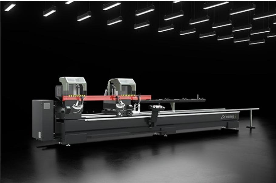
双头电子切割机、配备了通过数控无刷电机控制的活动切割头自动移动装置。具有 3 个固定位置（向外 90°、45°、22°30'）或者配有中间角度手动调节机械系统的切割单元气动倾斜装置。气动油压刀片进给。
