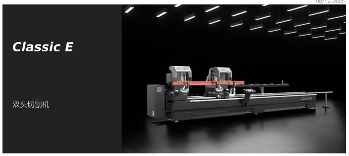
双头电子切割机、配备了通过数控无刷电机控制的活动切割头自动移动装置。具有 3 个固定位置(向外90°、45°、22°30′)或者配有中间角度手动调节机械系统的切割单元气动倾斜装置。气动油压刀片进给。
