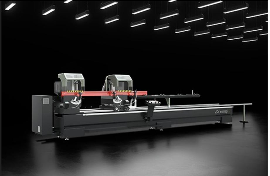
双头电子切割机、配备了通过数控无刷电机控制的活动切割头自动移动装置。具有 3 个固定位置（向外 90°、45°、22°30'）或者配有中间角度手动调节机械系统的切割单元气动倾斜装置。气动油压刀片进给。
