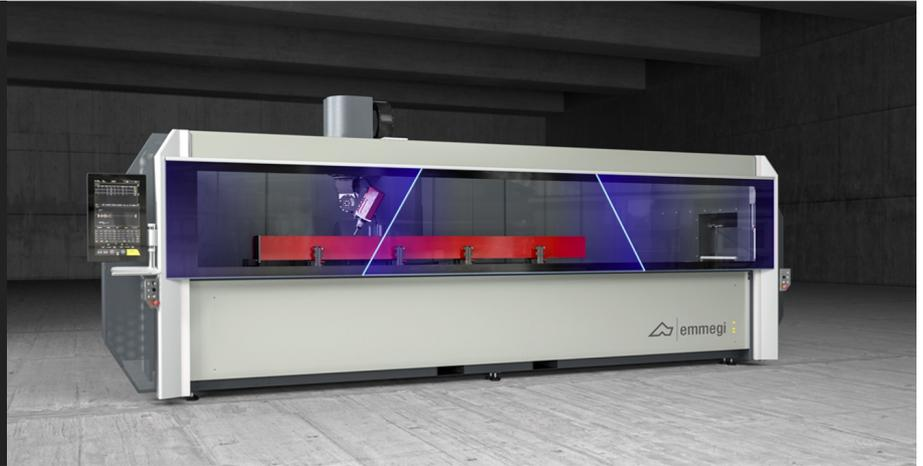
带有 5 个控制轴的数控加工中心，专门用于加工铝、PVC、一般轻合金和钢材质的棒材或工件，长度不超过 4 米。第 4 轴和第 5 轴允许电动主轴受数控系统控制在水平轴（ $-15^{\circ}$  到  $+90^{\circ}$ ）和垂直轴（ $-360^{\circ}$  到  $+360^{\circ}$ ）上连续旋转，以便加工型材的上表面和所有侧面。加工中心的 X 轴滑架上有一个 12 刀位的刀具库，也可以容纳一个圆盘铣刀。还配有一个活动工作台，方便工件装卸，大大增加了可加工截面。
