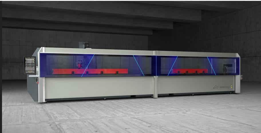
4 控制轴的 CNC 加工中心，用于加工型材或铝合金、PVC、普通轻质合金工件。这里具有两种不同的工作模式：第一种为单区域模式，可以在最大长度 7 m 的整个棒材的单个加工区域进行加工；第二种为交替模式，可以在两个不同的加工区域对多个工件进行加工。所有 CN 轴都是绝对轴，机器重新启动时不需要归零。HP 版本的机床配有 2 个辅助轴，在交替模式下，可以在相反的加工区域，在主轴加工流程攻丝时间内对虎钳和参考挡块进行定位。第四轴允许电动主轴受数控系统控制在水平轴上旋转 -120° 至 +120°，以便在型材的上表面和侧面上进行加工。配有 12 位刀库、位于 X 轴车架上、可以容纳一个角形工具和一个铣刀盘、对工件 5 个面。活动工作台能够以完全符合人体工学的方式，方便进行工件的装卸，并大大增加了 Y 轴上的加工截面。
