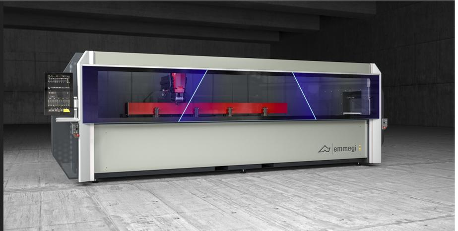
带有 4 个控制轴的数控加工中心、专门用于加工铝、PVC、一般轻合金和 2 毫米及以下钢材质的棒材或工件。配有一个 10 刀位的刀具库、可以容纳一个转角单元和一个圆盘铣刀、用于加工工件的 5 个面、可以加工最长为 4 米的棒材。第 4 数控轴允许电动主轴在  $0^{\circ}$  到  $180^{\circ}$  范围内旋转并定位在任何中间角度位置。因此、机器可以对范围内任何倾斜角度的型材的侧面和上表面进行加工。加工中心还配有一个活动工作台、方便工件装卸、大大增加了可加工截面。
