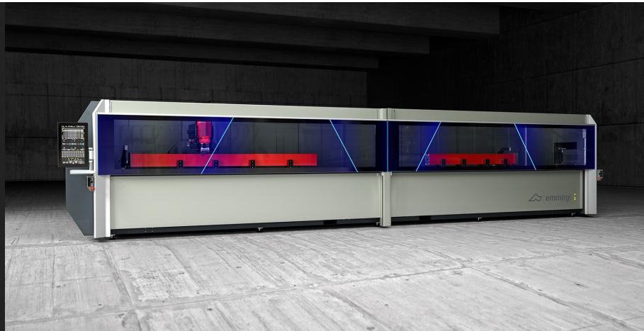
带有 4 个控制轴的数控加工中心、专门用于加工铝、PVC、一般轻合金和钢材质的棒材或工件、长度不超过 2 米。
