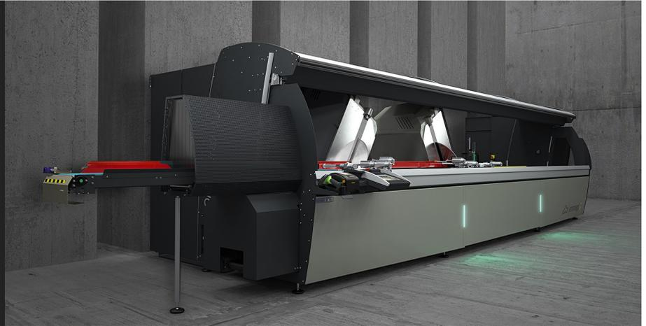
9 轴受控双头切割机、包括移动头的自动移动装置、切割单元两个旋转轴的电子管理装置、刀片的推进装置以及切割单元的垂直平移装置、能够以最大限度地扩大工作范围。这款切割机可以在水平轴上达到 45°（内部）到 22°30'（外部）、垂直轴上从 0 到 45° 的角度、并具有小数位的切割精度。机器有两个版本：Compound Cut L 用于切割截面较大、正常厚度的轻质型材；Compound Cut H 用于切割抗切割性能较高、厚度较大、或其几何形状需要刀片接触弧长较大的重型型材。600 毫米的 Widia 刀片可在两个轴上推进、从而优化垂直方向的切割形状、能够切割高度超过 500 毫米的型材、并能确保以最佳方式调整刀片速度和输出行程。HS（高速）版配有高速 X 轴和自动加工所需的所有护板。
