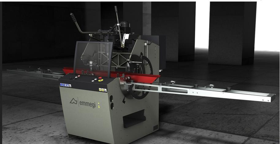
手动控制的单头受电弓、可以进行气动夹持并通过间接杠杆平移切割头。可以加工最大尺寸为 2 毫米的钢材和寸为 2 毫不锈钢（选配）。配备了夹持台旋转系统、机床可以加工型材的 4 个面、无需松开虎钳、或进行通体式加工、可在 90° 扇形范围内旋转 270°。四个气动挡板确保夹紧型材。加工区域配有气动保护装置。旋转装置能够提高加工速度和精度、通过取消通体式加工来使用更短的刀具、并可以减少振动和噪音。
