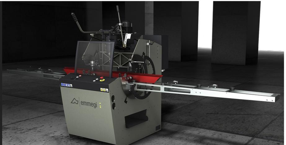
手动控制的单头受电弓、可以进行气动夹持并通过间接杠杆平移切割头。可以加工最大尺寸为 2 毫米的钢材和寸为 2 毫不锈钢（选配）。配备了夹持台旋转系统、机床可以加工型材的 4 个面、无需松开虎钳、或进行通体式加工、可在 90° 扇形范围内旋转 270°。四个气动挡板确保夹紧型材。加工区域配有气动保护装置。旋转装置能够提高加工速度和精度、通过取消通体式加工来使用更短的刀具、并可以减少振动和噪音。
