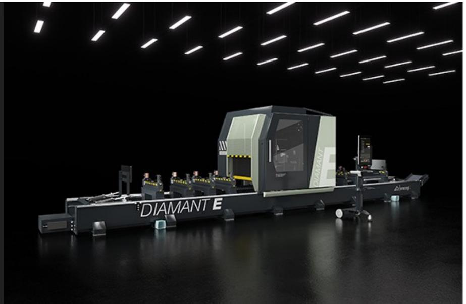
带移动机门 4 轴数控加工中心、可对大尺寸铝制型材杆、PVC 和轻型合金进行铣削、穿孔、螺纹加工和切割；对厚度 2 mm 及以下的钢材进行切割之外的加工。机器的移动部分由移动门构成、该移动门配备了高精度齿条的重机动装置。高功率电动主轴甚至可以执行重型加工、并在速度和精度方面均可获得良好效果。的机载防护舱旨在将最大的功能性、可及性性以及照明度与对安全性和人体工学的需求相结合。操作员可以利用大面积的透明玻璃表面来检查加工执行情况、并可以在清洁和维护阶段轻松进入。防护舱内部的刀库和滑动架上的其他配件与工作区完全隔离、可以最大限度地确保将切屑收集到传送带上、并可以选配专门抽吸加工烟气的吸尘装置。集成到移动机门上的 12 位刀具库可容纳一个最大直径 300 毫米的刀片。动态版机床具有 1 个辅助轴、用于虎钳的定位、可以在交替模式运行过程中的掩蔽时间内进行定位。参考挡块可以在对型材头上进行加工时脱离该区域。所有 CNC 轴都是绝对轴、机器重新启动时不需要归零。
