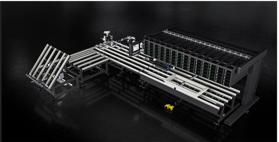
自动工作台用于将恒定或可变螺距的五金件拧到窗框上、工作台面宽大、可移动和旋转大型窗框。
