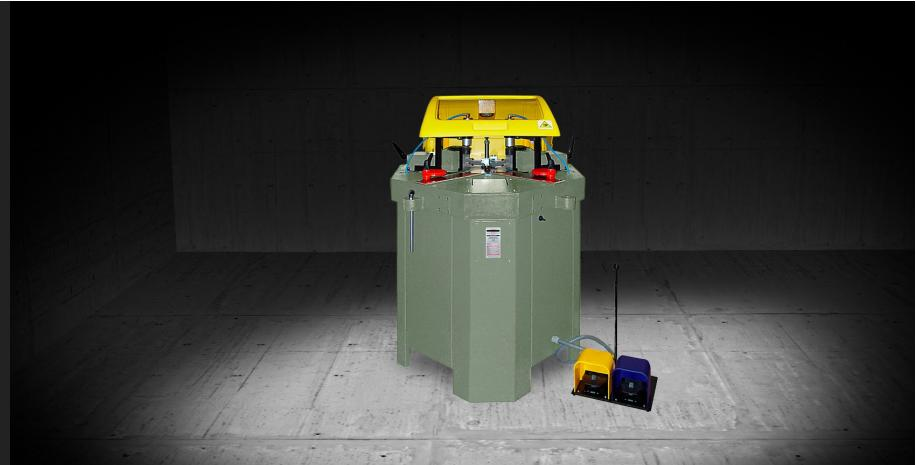
用于所有类型的铝型材收脚的斜切机。冲孔单元可以平移，方便调节。刀具块配备了快速释放装置和磁铁，以防止刀具块脱落，易于使用，用途广泛。
