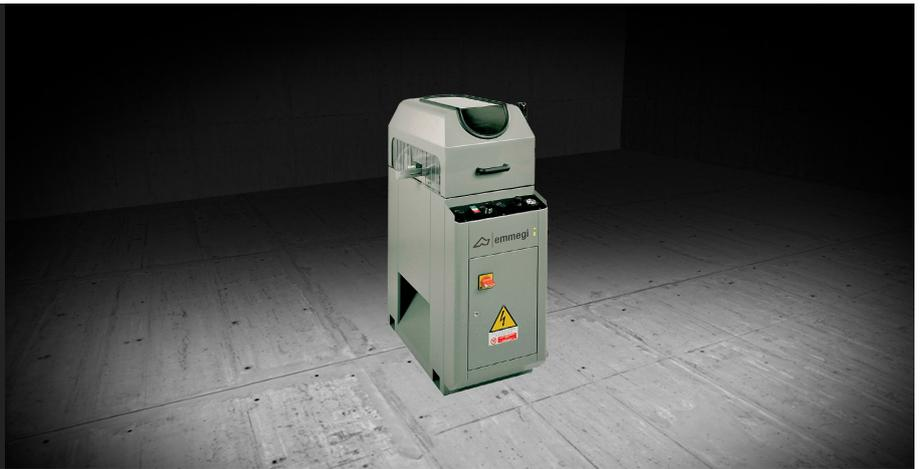
水平端面铣削机，带手动进给装置。方框外铣削角度  $+45^{\circ}/90^{\circ}/-45^{\circ}$ 。气动控制的铣刀组件快速更换装置。防刮加工台面。加工区一体式保护装置。
