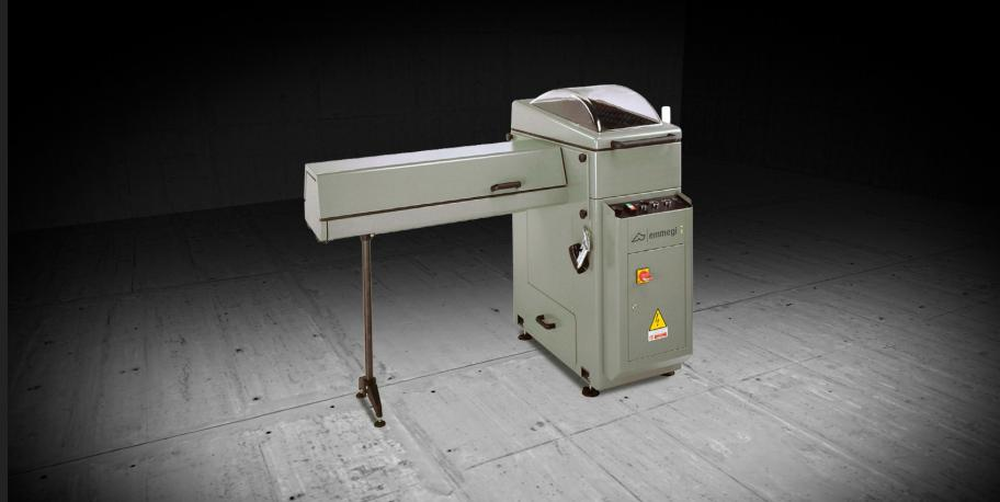
水平端面铣削机，带电动气动进给装置和自动加工循环。方框外铣削角度 +45°/90°/-45°。
