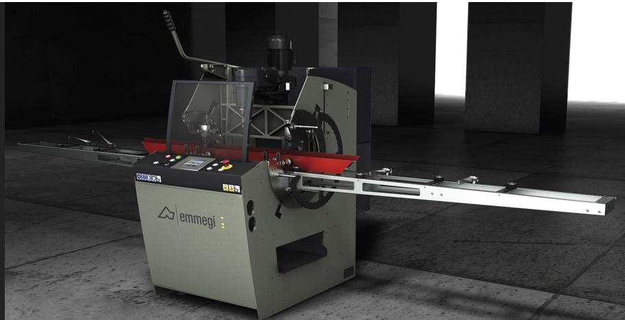
带 2 个控制轴的单头受电弓是加工铝、PVC 和 2 毫米及以下钢型材的理想选择。另外、还可以加工 2 毫米及以下的不锈钢（选配）。通过直观的软件来管理工作周期、软件能够通过触屏上的简单指示来引导操作员。USB 接口可以轻松连接计算机。4 面旋转的工作台面可以提高加工的速度和精度。还可以使用较短的刀具、最大限度地减少通体式加工导致的振动和噪音。ISO 30 快速换刀装置。加工区的气动控制防护装置。
