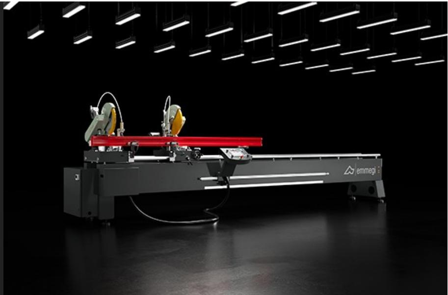
双头切割机、配有移动切割头的手动移动装置、通过绝对磁条检测其位置。切割单元在垂直轴上的旋转（向左右 45°）和在水平轴上的倾斜（向内侧 45°）可以进行手动调整、允许在中间角度进行组合切割。
