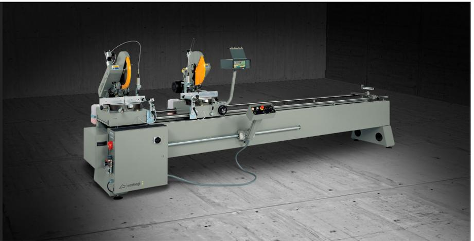
双头切割机，配有移动切割头手动移动装置，带数字高度显示器 (Norma Vis)。切割单元的旋转装置（左右 45°）和手动翻转装置（相对于水平轴 45°）。刀片 400 毫米。可提供 4 米或 5 米的有效切割长度。
