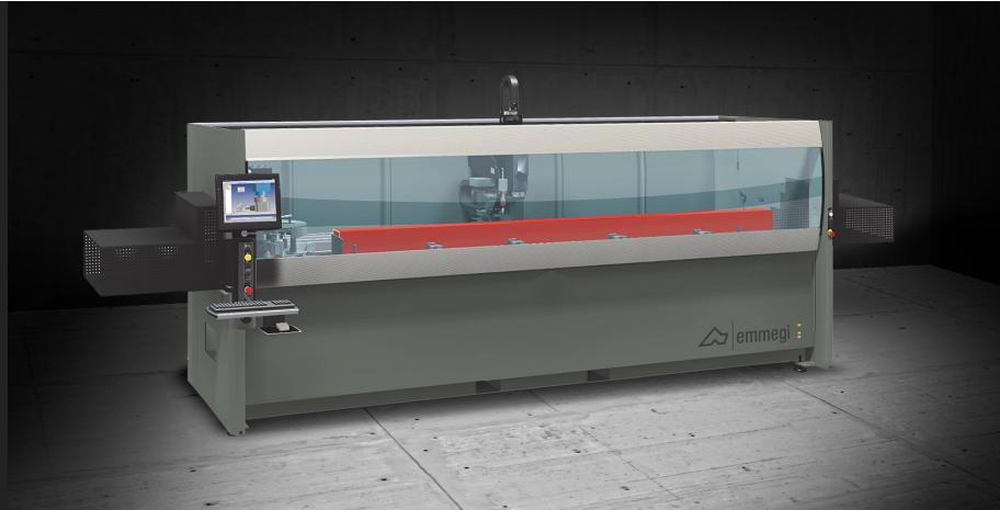
带有 3 个控制轴的数控加工中心，专门用于加工铝、PVC、一般轻合金和 3 毫米及以下钢材质的棒材或工件。配有一个 4 刀位的刀具库，可以容纳 2 个转角单元和一个圆盘铣刀，用于加工工件的 5 个面。所有数控轴都是绝对轴、在机床重新启动时不需要重新设置。加工中心还配有一个活动工作台，方便工件装卸，大大增加了可加工截面。
