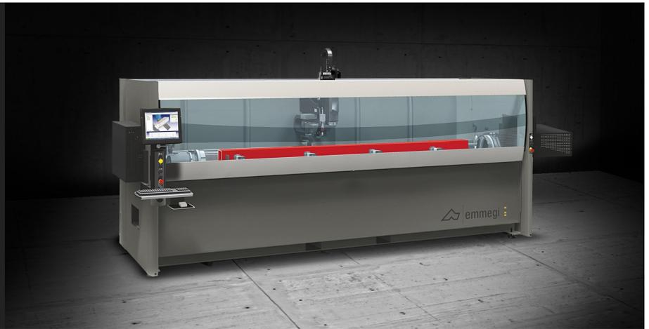
带有 4 个控制轴的数控加工中心、专门用于加工铝、PVC、一般轻合金和 3 毫米及以下钢材质的棒材或工件。配有一个 4 刀位的刀具库、可以容纳 2 个转角单元和一个圆盘铣刀、用于加工工件的 5 个面。机器包含的旋转工作台面（数控轴）可以执行从  $-90^{\circ}$  到  $+90^{\circ}$  的任何角度的加工、并且可以在台面位于  $0^{\circ}$  位置时、对带有双输出转角单元的两个顶端进行加工。所有数控轴都是绝对轴、在机床重新启动时不需要重新设置。
