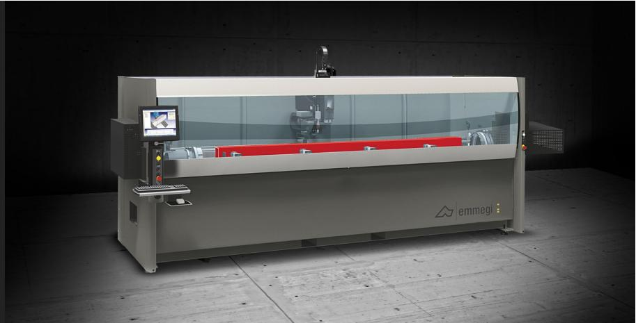
带有 4 个控制轴的数控加工中心、专门用于加工铝、PVC、一般轻合金和 3 毫米及以下钢材质的棒材或工件。配有一个 4 刀位的刀具库、可以容纳 2 个转角单元和一个圆盘铣刀、用于加工工件的 5 个面。机器包含的旋转工作台面（数控轴）可以执行从 -90° 到 +90° 的任何角度的加工、并且可以在台面位于 0° 位置时、对带有双输出转角单元的两个顶端进行加工。所有数控轴都是绝对轴、在机床重新启动时不需要重新设置。
