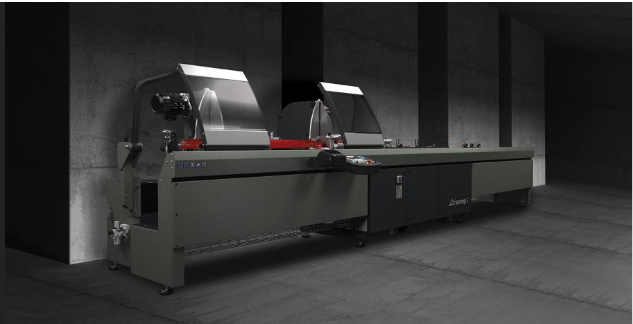
电子双头切割机配有数控控制的移动切割头无刷电动机自动移动装置。切割单元的气动倾斜度从 90° 到 22°30' (外角) , 配有中间角度机械调节系统。气动油压刀片进给装置。
