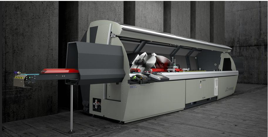
带 5 个控制轴的双头切割机、用于切割铝、和轻合金、移动切割头自动移动、从 22°30' (内侧) 到 45° (外侧) 的所有角度均实现高精度电子化管理、每个角度内有 280 个位置。600 毫米的硬合金刀片可在两种不同模式下推进。标准进给优化了垂直方向的切割形状、能够切割高度超过 450 毫米的型材。径向模式利用超出垂直参考平面的宽大行程、在水平方向上生成一个宽阔的曲线。这一解决方案允许切割宽度 240 mm 及以下的型材。机器有两个版本：PRECISION RS L 用于切割截面较大、正常厚度的轻质型材；PRECISION RS H 用于切割抗切割性能较高、厚度较大、或其几何形状需要刀片接触弧长较大的重型型材。刀片的进给由一对 CN 轴驱动、以保证对刀片的速度和离开路径的最佳调节。H S (High Speed) 版本具有更高的 X 轴速度和所有必要的保护措施、甚至可以在无人值守的状态下进行自动加工。
