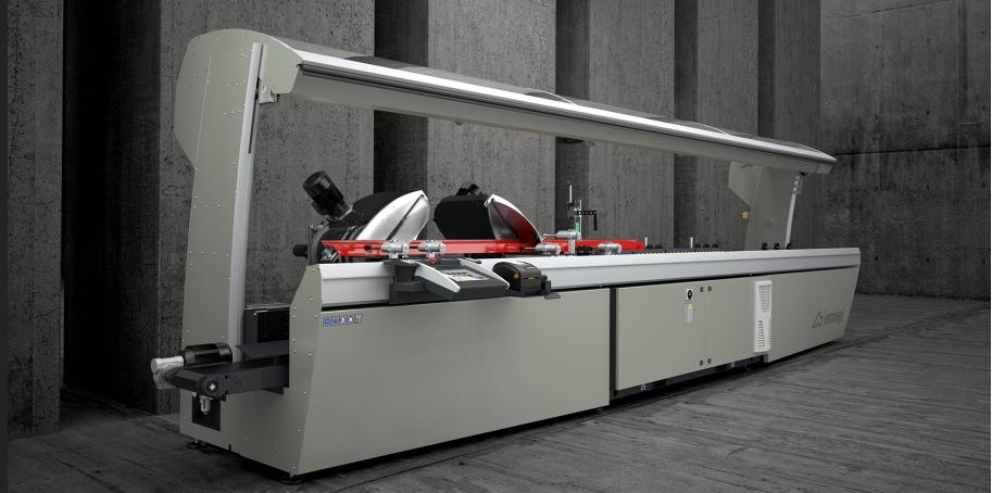
带 5 控制轴的双头切割机，用于切割铝、PVC 和轻合金，移动切割头自动移动，从 45°（内侧）到 15°（外侧）的所有角度均实现高精度电子化管理，每个角度内有 280 个位置。在基本版本中，刀片进给由一对气动油压缸驱动。在 E 版本中，刀片进给也由一对数控轴管理，能够以最佳方式调节刀片速度和行程。刀片 550 毫米。可提供 5 米或 6 米的有效切割长度。
