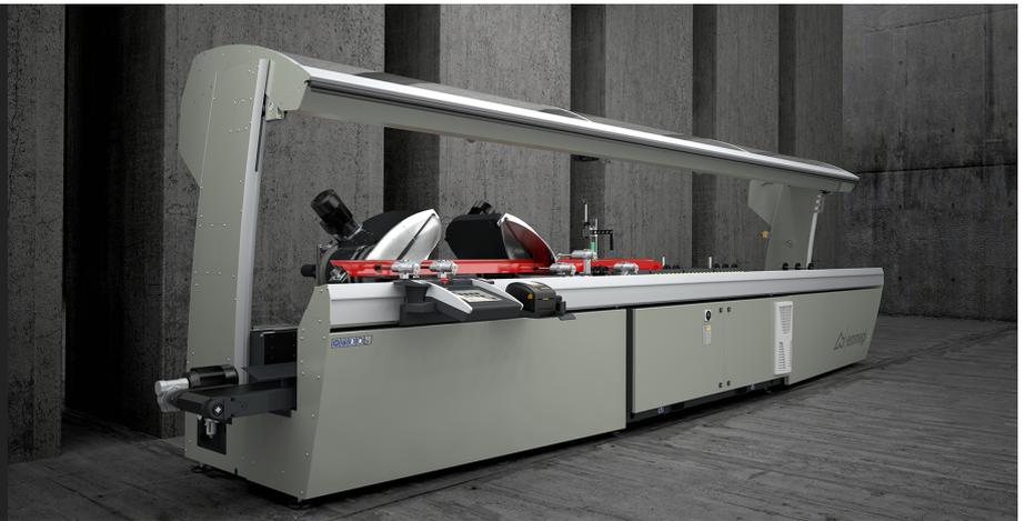
带 5 控制轴的双头切割机，用于切割铝、PVC 和轻合金，移动切割头自动移动，从 45°（内侧）到 15°（外侧）的所有角度均实现高精度电子化管理，每个角度内有 280 个位置。在基本版本中，刀片进给由一对气动油压缸驱动。在 E 版中，刀片进给也由一对数控轴管理，能够以最佳方式调节刀片速度和行程。刀片 550 毫米。可提供 5 米或 6 米的有效切割长度。
