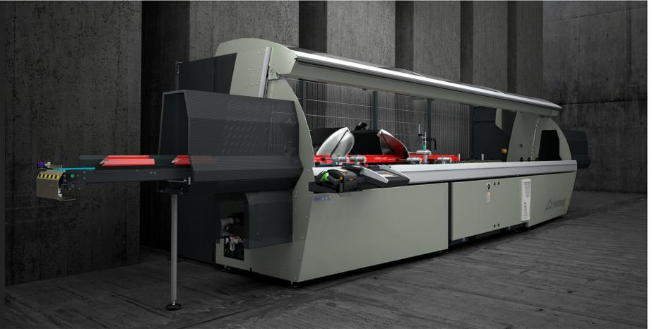
带 5 控制轴的双头切割机，用于切割铝、PVC 和轻合金，移动切割头自动移动，从 45°（内侧）到 15°（外侧）的所有角度均实现高精度电子化管理，每个角度内有 280 个位置。在基本版本中，刀片进给由一对气动油压缸驱动。在 E 版中，刀片进给也由一对数控轴管理，能够以最佳方式调节刀片速度和行程。刀片 550 毫米。可提供 5 米或 6 米的有效切割长度。HS (High Speed) 版本具有更高的 X 轴速度和所有必要的保护措施，甚至可以在无人值守的状态下进行自动加工，实现最大的生产效率。
