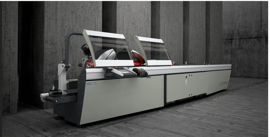
带有 3 个控制轴的双头切割机、移动切割头自动移动、从 45°（内侧）到 15°（外侧）的所有角度均实现高精度电子化管理、每个角度内有 280 个位置。刀片进给由一对气动油压缸驱动。
