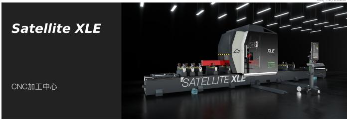
带移动龙门架的 5 轴数控加工中心,可对大尺寸铝、PVC、一般轻合金及钢质棒材进行铣削、钻孔、螺纹加工和切割。机床的活动部分由一个配备了精密齿轮齿条驱动的龙门架构成。高功率电动主轴(S1 中为 11 千瓦)带有 HSK-63F
