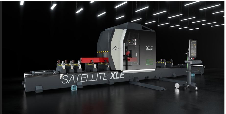
带移动龙门架的 5 轴数控加工中心，可对大尺寸铝、PVC、一般轻合金及钢质棒材进行铣削、钻孔、螺纹加工和切割。机床的活动部分由一个配备了精密齿轮齿条驱动的龙门架构成。高功率电动主轴（S1 中为 11 千瓦）带有 HSK-63F
