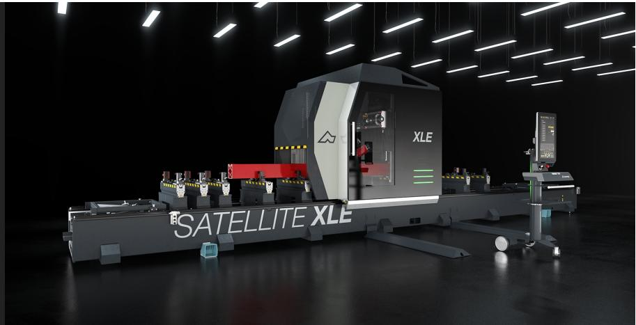
带移动龙门架的 5 轴数控加工中心，可对大尺寸铝、PVC、一般轻合金及钢质棒材进行铣削、钻孔、螺纹加工和切割。机床的活动部分由一个配备了精密齿轮齿条驱动的龙门架构成。高功率电动主轴（S1 中为 11 千瓦）带有 HSK-63F 刀具接头，甚至可以执行重型加工，并在速度和精度方面均可获得良好效果。全新局部保护舱的设计最大程度地将功能性、可及性以及照明度与安全性和人体工程学要求相结合。大面积的玻璃窗使操作员能够控制加工操作的执行情况，由于保护舱可以完全打开为两部分，操作员可以接触到内部零件进行维护和清洁。加工中心内部容纳了一个 18 刀位刀具库。450 毫米刀具单独存放在专用的刀具库中。SATELLITE XLE 具有新的电动虎钳，在交替模式下，虎钳会独立定位并在攻丝时间内与对面加工区域的主轴加工过程保持同步。虎钳坚固，占地小，易于配置，无需使用任何工具即可调节几何形状。全新挡块可以完全覆盖加工区域，在加工型材头时，挡块可以脱离该区域。所有数控轴都是绝对轴，在机床重新启动时不需要重新设置。
