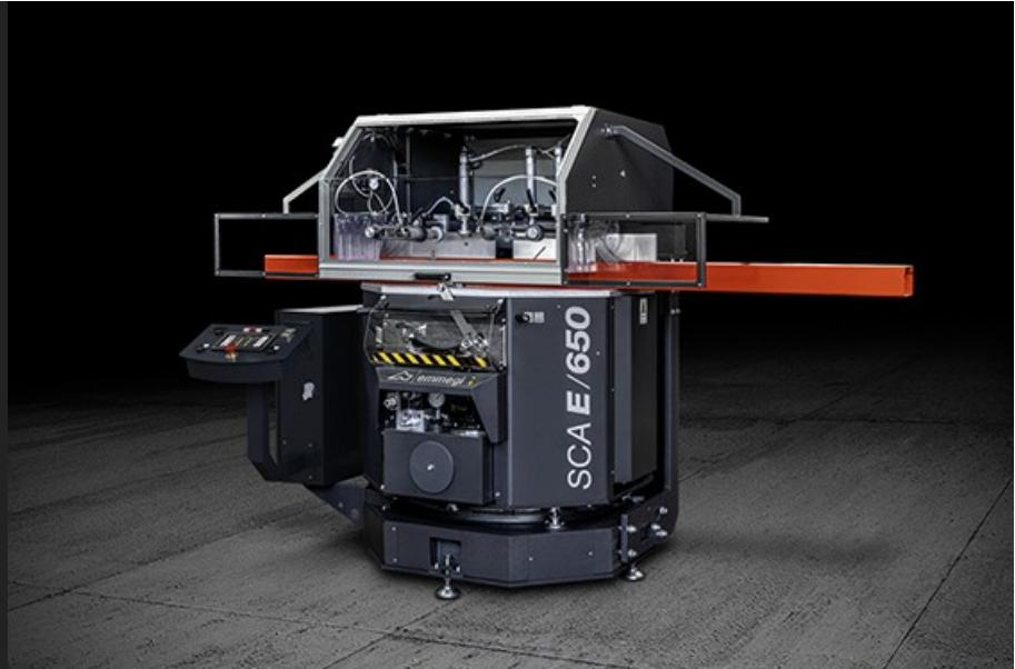
上升式单头切割机、带有无刷电机驱动的垂直轴数控自动旋转装置、水平轴还可以通过液压控制同时实现翻转。垂直轴上的切割角度为 90° 至 22°30' (左右两侧) 、水平轴上为 90° 至 35° (仅右侧) 。
